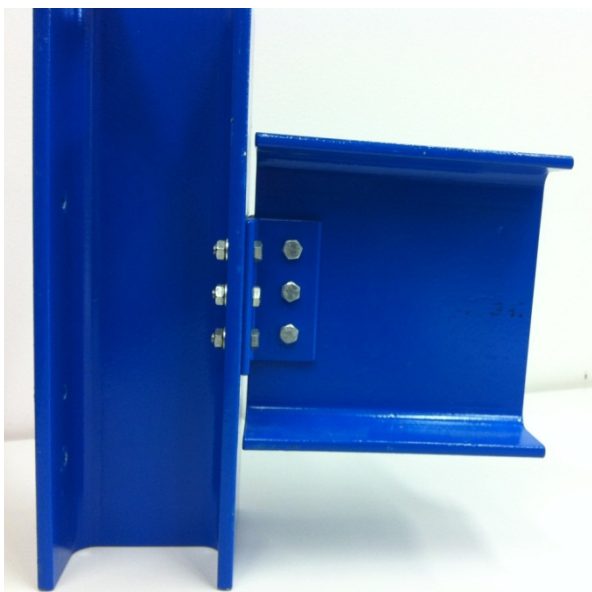
Figure 4 – Photo et modèle statique d'un assemblage poutre-poteau articulé
